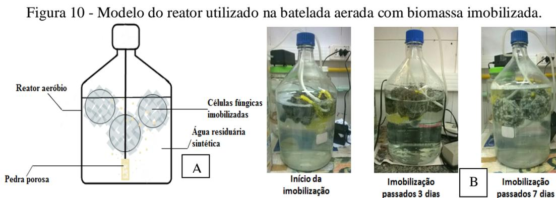
Legenda: A – Modelo do reator utilizado nas bateladas aeradas; B – processos de imobilização do fungo. Fonte: Autora, 2016.
