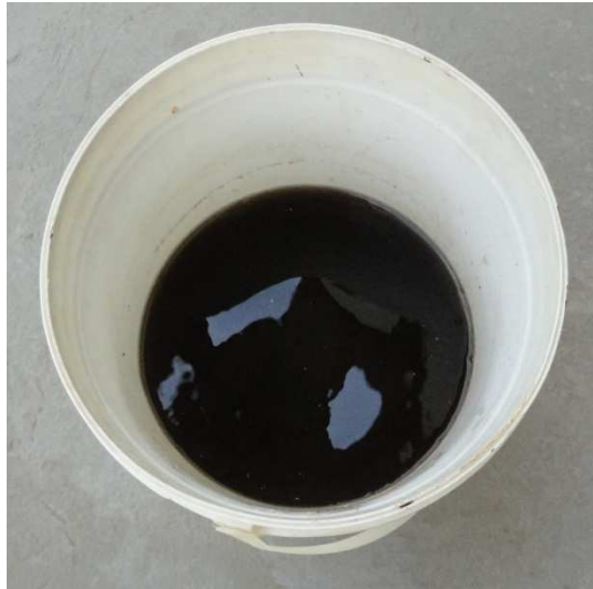
Figura 39 – Resíduos da crosta acumulada entre os eletrodos de aço carbono.
