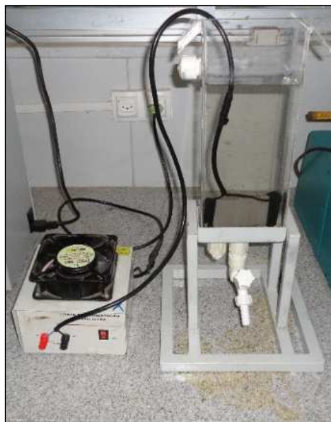
Figura 14 – Fonte de 13,8 volts e reator com o par de eletrodos.
