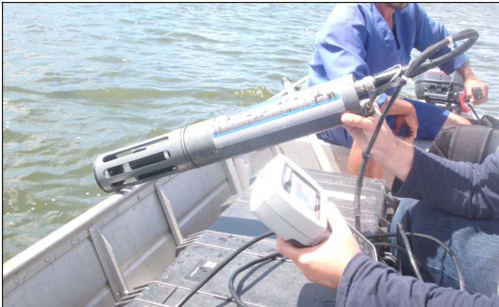
Figura 10 - Sonda multiparamétrica utilizada para realizar a perfilagem no açude Gavião.
