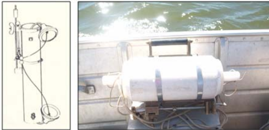
Figura 11 - Amostrador de Van Dorn utilizado nas campanhas de amostragem.
