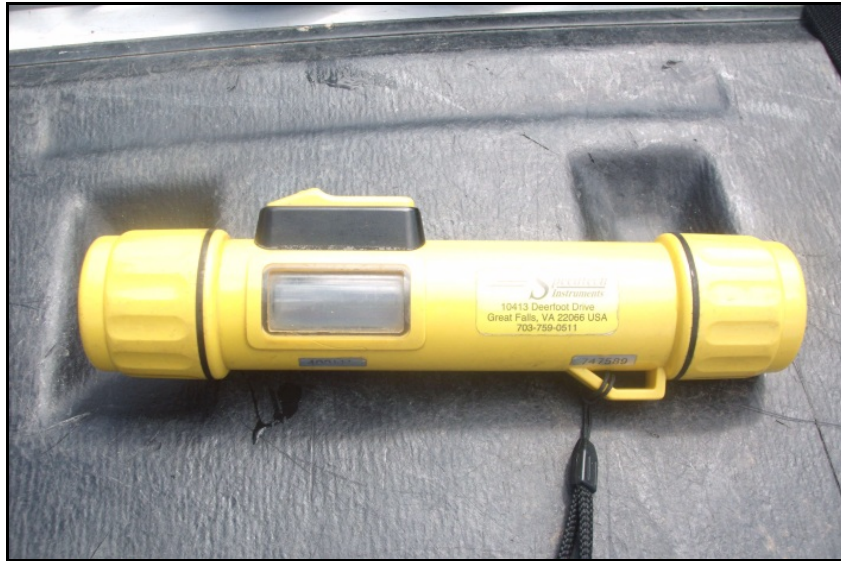
Figura 12 - Profundímetro digital utilizado para medir a profundidade máxima em cada ponto de amostragem no açude Gavião.
