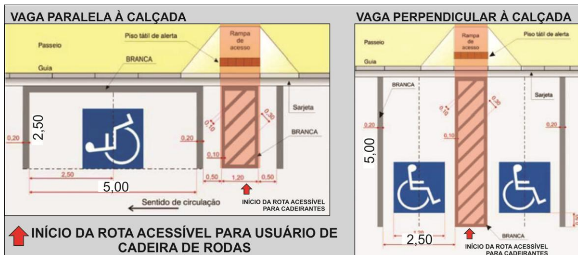
Figura 2.26: Dimensões de vagas em estacionamento .
