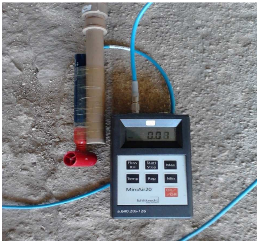
Figura 4-9 Anemômetro eletromagnético utilizado nas medições de velocidade da água
