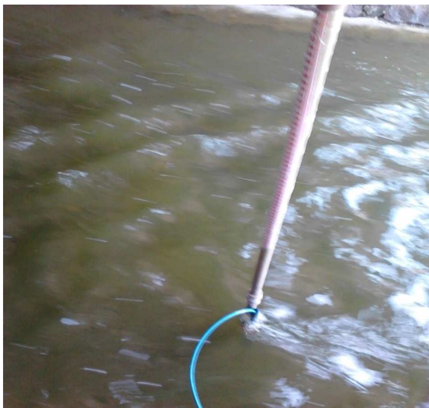
Figura 4-10 Medição da altura da lâmina d'água no canal
