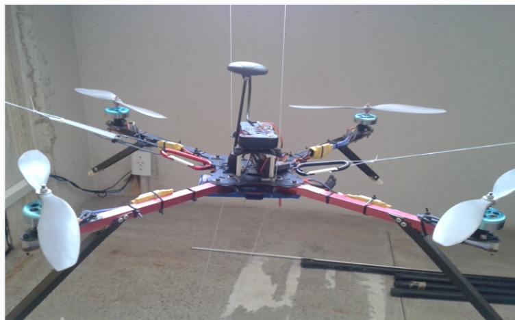
Figura 1 – Quadrirrotor desenvolvido e utilizado nesta pesquisa.
