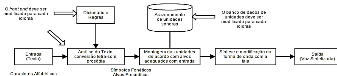
Figura 3.3 - Diagrama de blocos da síntese concatenativa.
