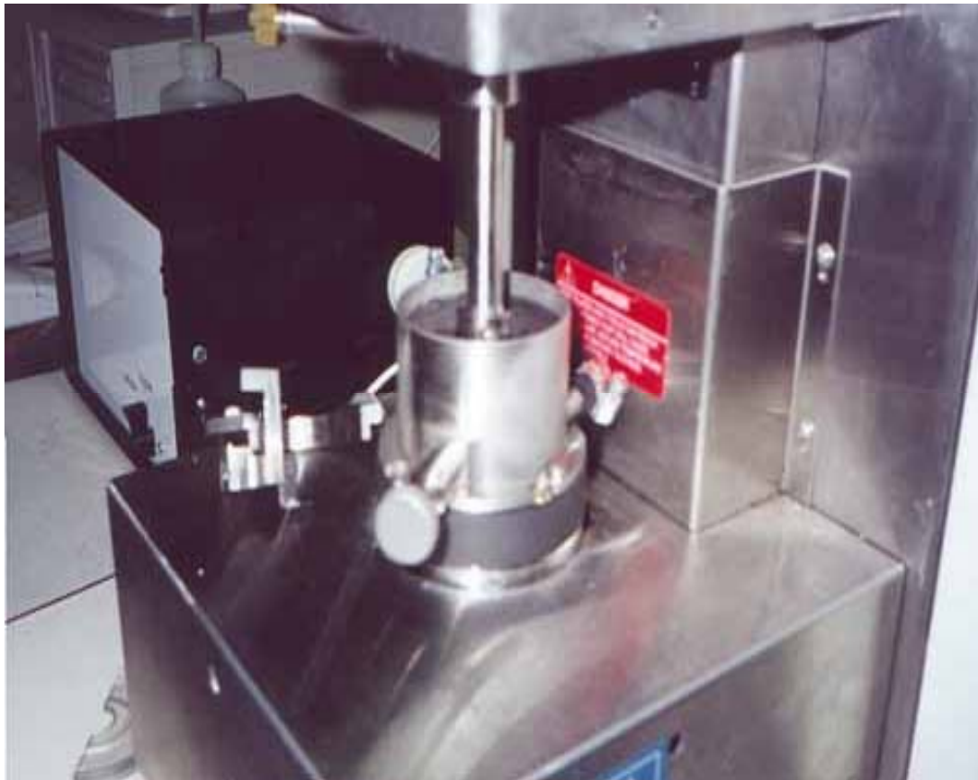
Figura 13. Foto ilustrativa do DSR com geometria de placa paralela.
