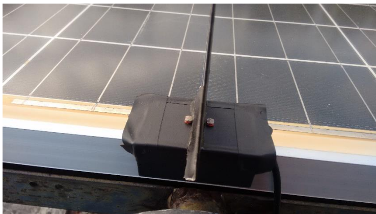
Figura 4.20 – Placa do circuito dos LDR's com a caixa de proteção e a placa de sombreamento
