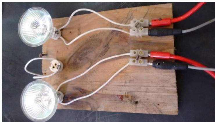
Figura 4.27 – Lâmpadas utilizadas como cargas para os módulos FV
