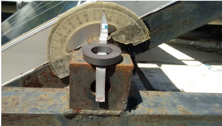
Figura 4.16 – Transferidor para verificação da posição angular do módulo
