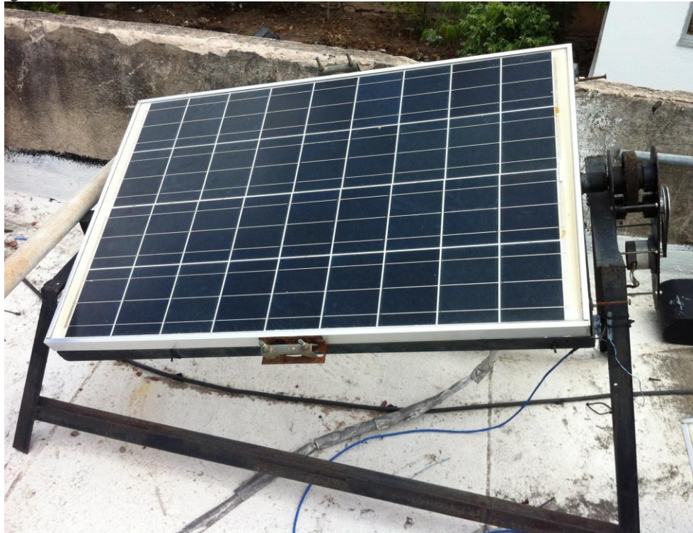
Figura 4.8 - Seguidor solar desenvolvido no LEA .
