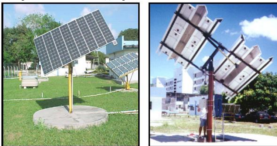
Figura 3.7 - (a) Seguidor ativo de um eixo e (b) Seguidor ativo de dois eixos com concentrador
