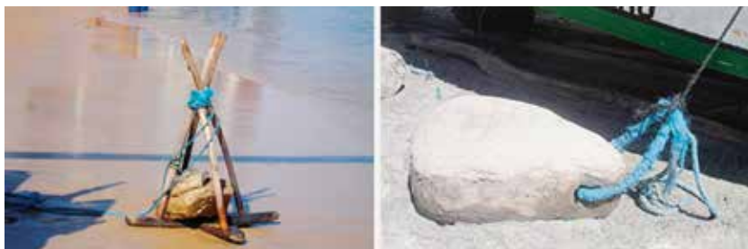
Figura 5 - Na foto da esquerda vê-se a fateixa e na foto da direita o tuaçu. (Fotos: Miguel S. C. Braga).
