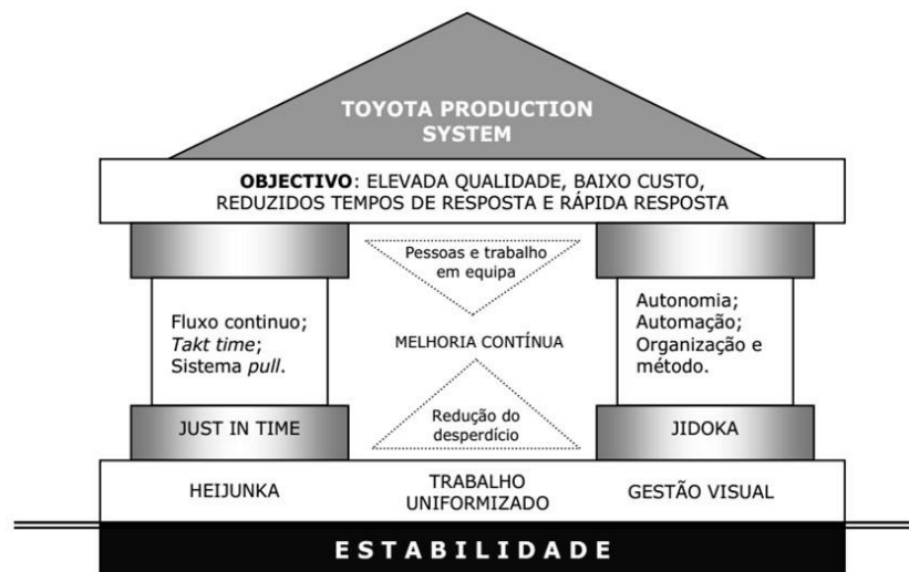
Figura 8. Sistema de Produção da Toyota ( Toyota Production System ) Fonte: Pinto (2009)
