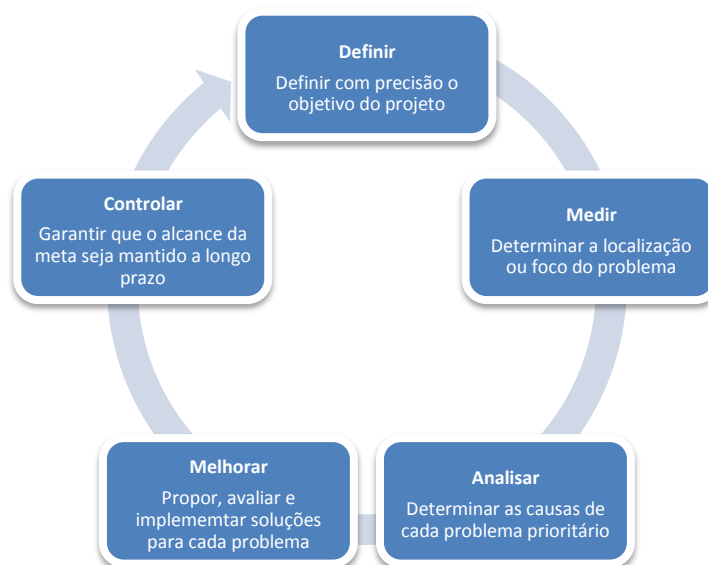
Figura 10. Modelo do ciclo DMAIC Fonte: Adaptado de Quintaneiro (2014)
