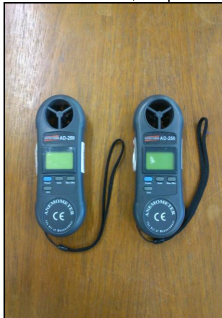
Figuras 20 e 21 - Anemômetro e Psicrômetro digitais utilizados na aferição dos dados de velocidade dos ventos, temperaturas e umidades.
