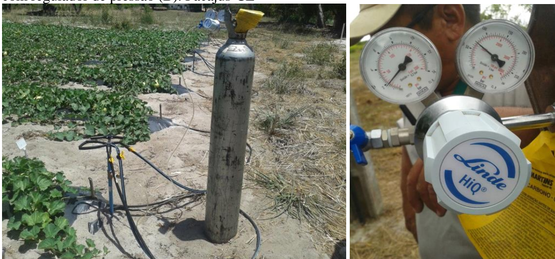
Figura 2 - Funcionamento da injeção de CO 2 em campo na área experimental (A) e manômetro com regulador de pressão (B). Pacajus-CE
