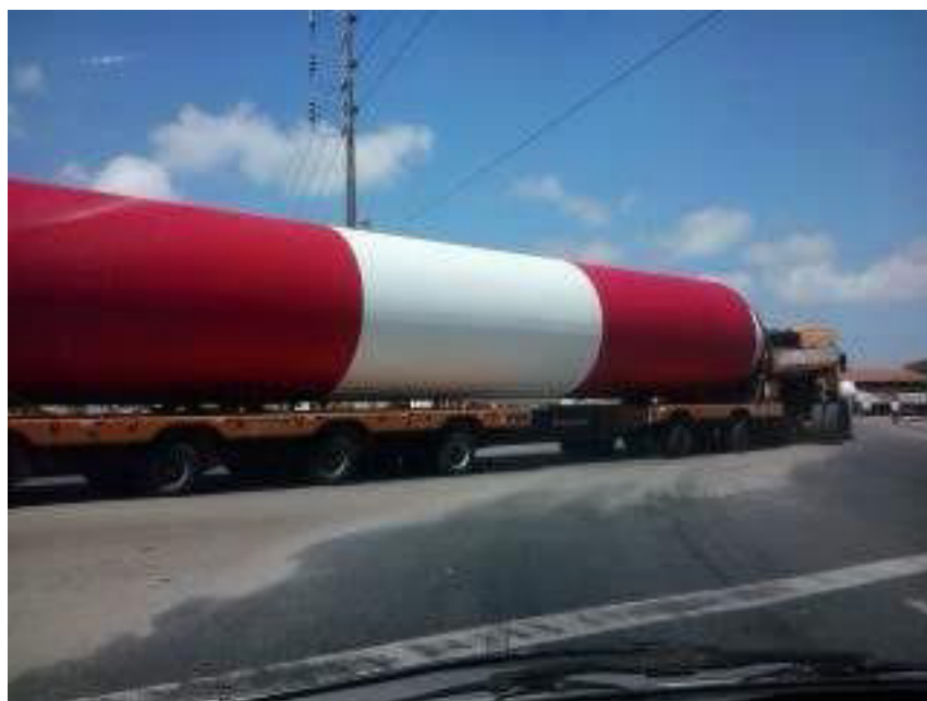
Figura 26. Transporte de parte de um aerogerador no Anel Viário de Fortaleza. Fonte: SILVA, 2014.
