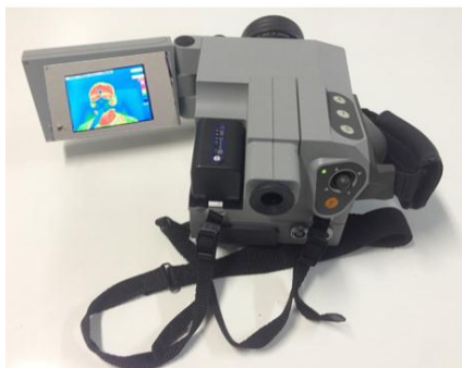
Figura 16 - Equipamento utilizado para Termografia infravermelha.
