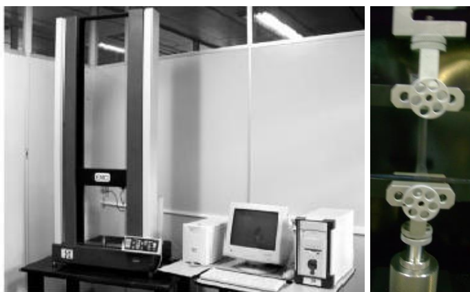
Figura 05: Máquina Universal de Ensaio – EMIC DL-3000
