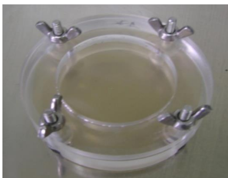
Figura 04: Cápsula de permeabilidade ao vapor de água
