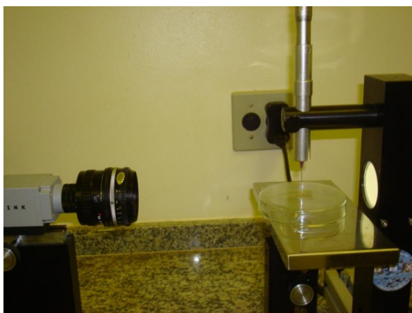
Figura 07: Sistema de medida de ângulo de contato
