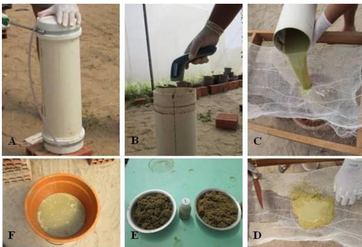
Figura 3 - Abertura dos reatores e obtenção das amostras para realização das análises químicas.
