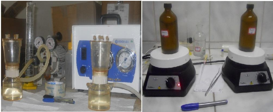
a b Figura 20. Separação das frações: a) kit de filtração de separação da fração dissolvida da particulada e b) amostra isenta do MPS, seguindo procedimento de extração em duplicata.
