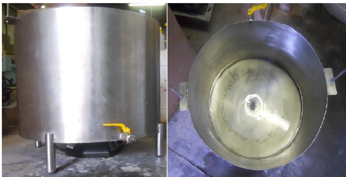
Figura 19. a) Sistema reacional de aço-inox sob o agitador magnético (frontal); b) Com a barra magnética, vista da face superior do sistema reacional
