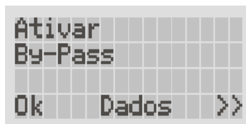
Figura 4.18 -Tela de ativação do modo bypass.
