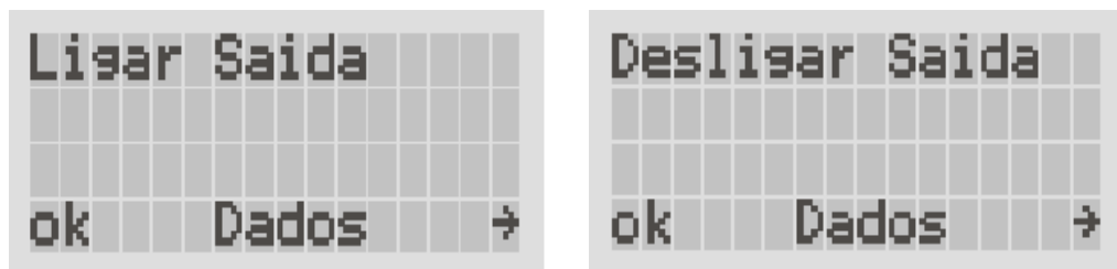
Figura 4. 16 Tela no display da UPS para ativação do inversor.
