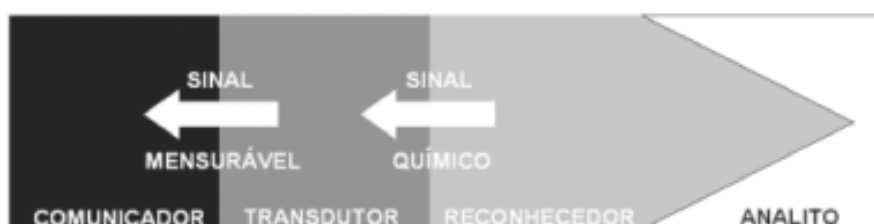
Figura 1 – Esquema de funcionamento de um sensor eletroquímico
