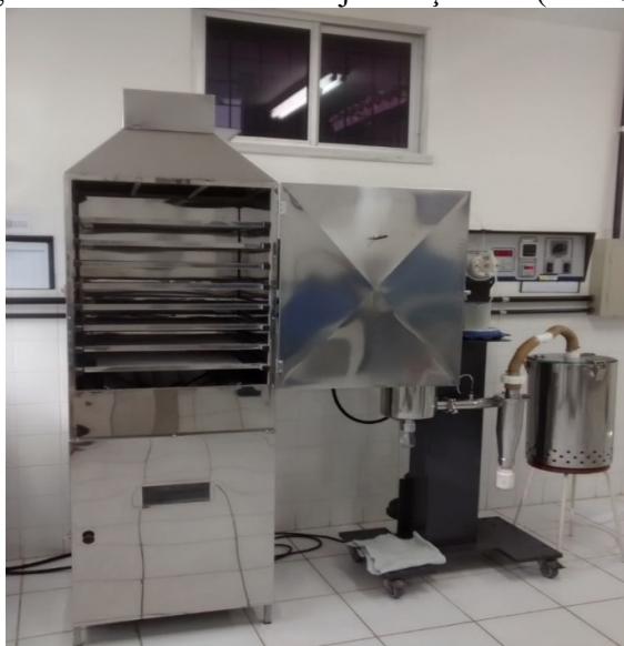
Figura 4 – Secador de bandeja de aço inox (AISI 304)
