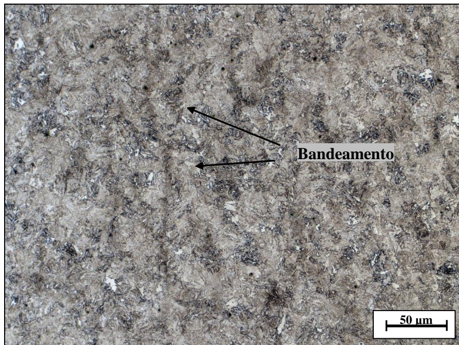
Figura 24. Microestrutura do metal base apresentando bandeamento.
