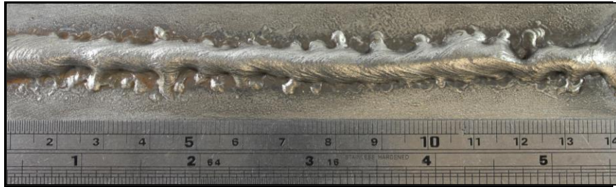
Figura 40. Exemplo de aspecto superficial defeituoso obtido na soldagem do arame AWS ER80S-B2 com o gás Ar + 25%He.
