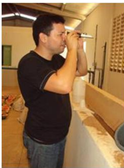
Figura 12. Leitura do ° Brix, com uso do refratômetro portátil
