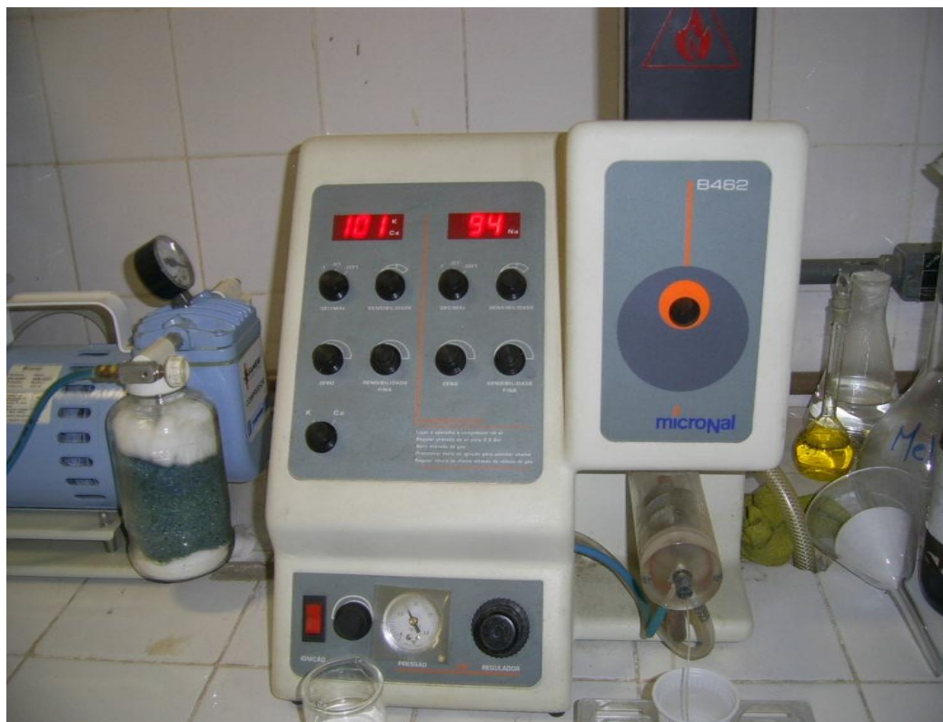
Figura 15 – Visualização do Espectrofotômetro de chama, Fortaleza, Ceará, 2010
