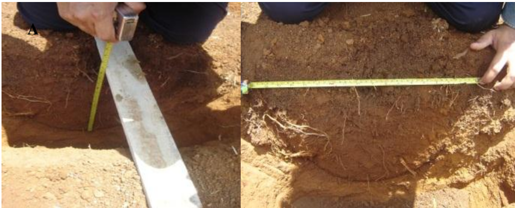
Figura 6 – Abertura de trincheiras para medição da profundidade (A) e do raio (B) do bulbo úmido na área experimental, Limoeiro do Norte, CE .
