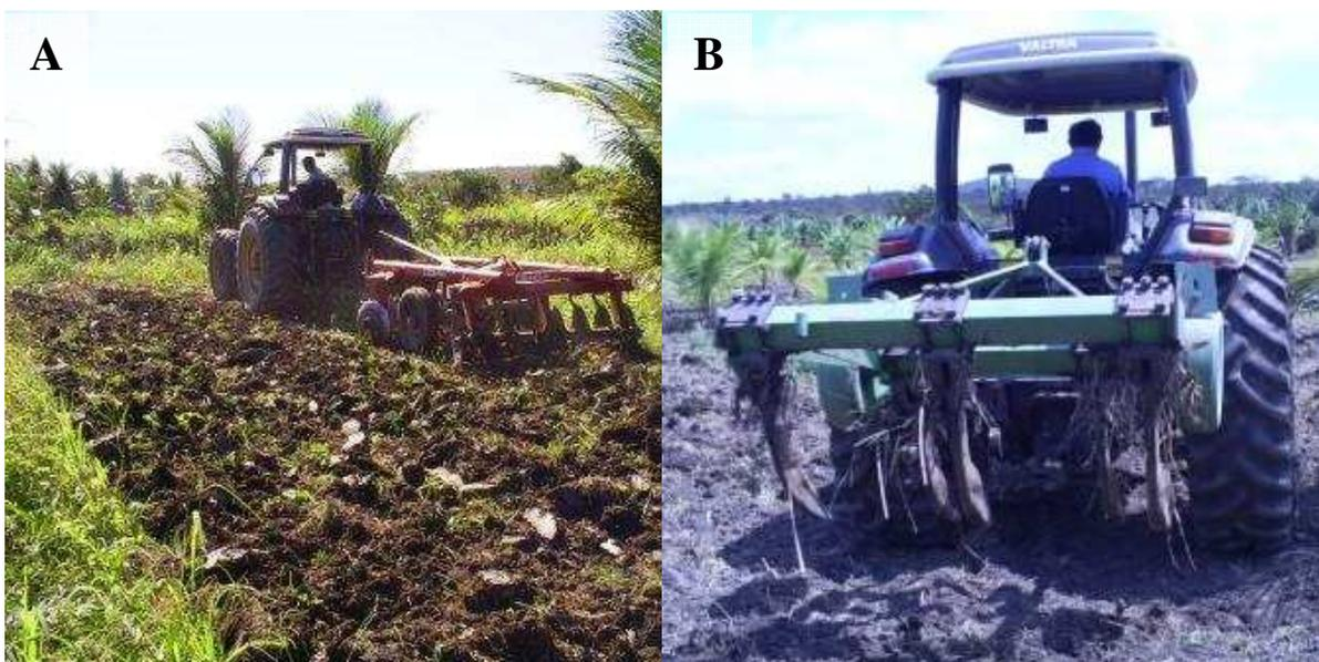
**Figura 2.2** Realização da gradagem (A) e subsolagem (B) na área
