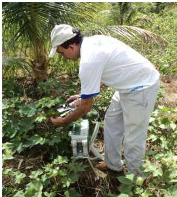
**Figura 4.3.** Medições das trocas gasosas foliares de algodão, utilizando-se um IRGA modelo LI 6400
