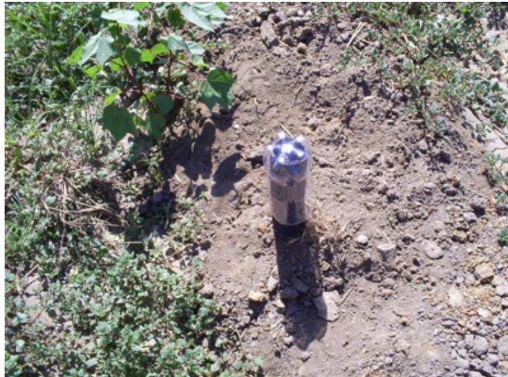
**Figura 2.8.** Detalhe do poço de observação instalado
