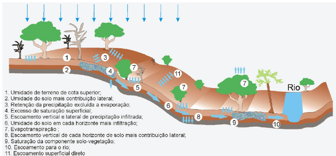
FIGURA 2 - Representação esquemática da série temporal do balanço hídrico do solo no modelo WASA a partir da atualização do teor de água do solo (MALVEIRA, 2009).
