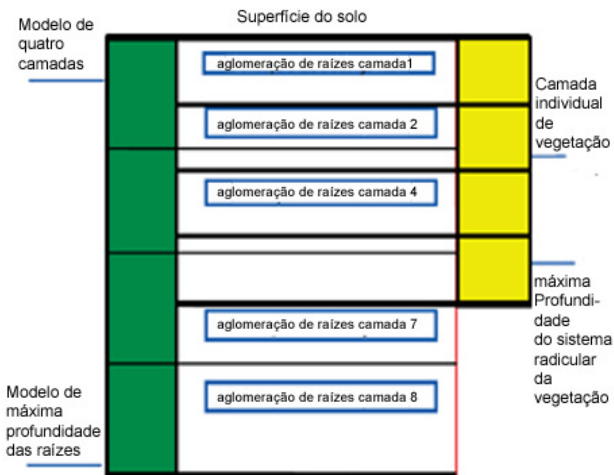
Figura 9.3. – Modelo esquemático da estrutura de mapeamento da profundidade do sistema radicular para as quatro camadas do DiCaSM (RAGAB e BROMLEY, 2010).
