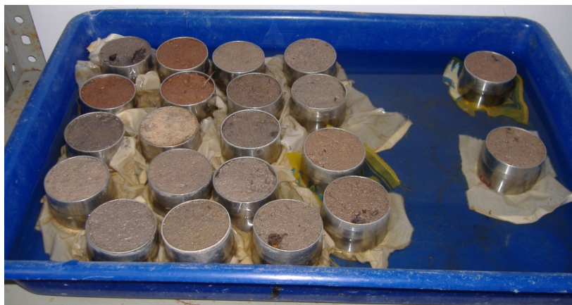
Figura 3.1 – Amostras submetidas ao processo de saturação por capilaridade.
