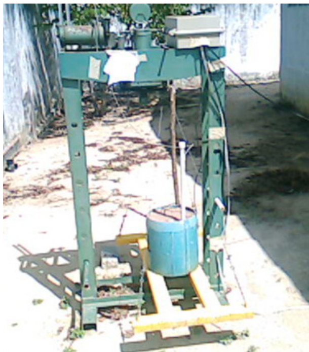
Figura 2.3 – Estrutura utilizada como balança e visão da amostra sobre a mesma.
