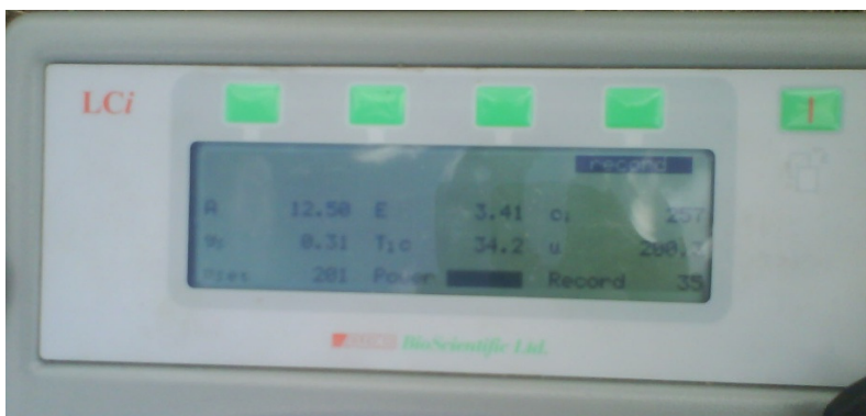
Figura 4.3 – Medidor de gás infravermelho a ser utilizado na pesquisa.
