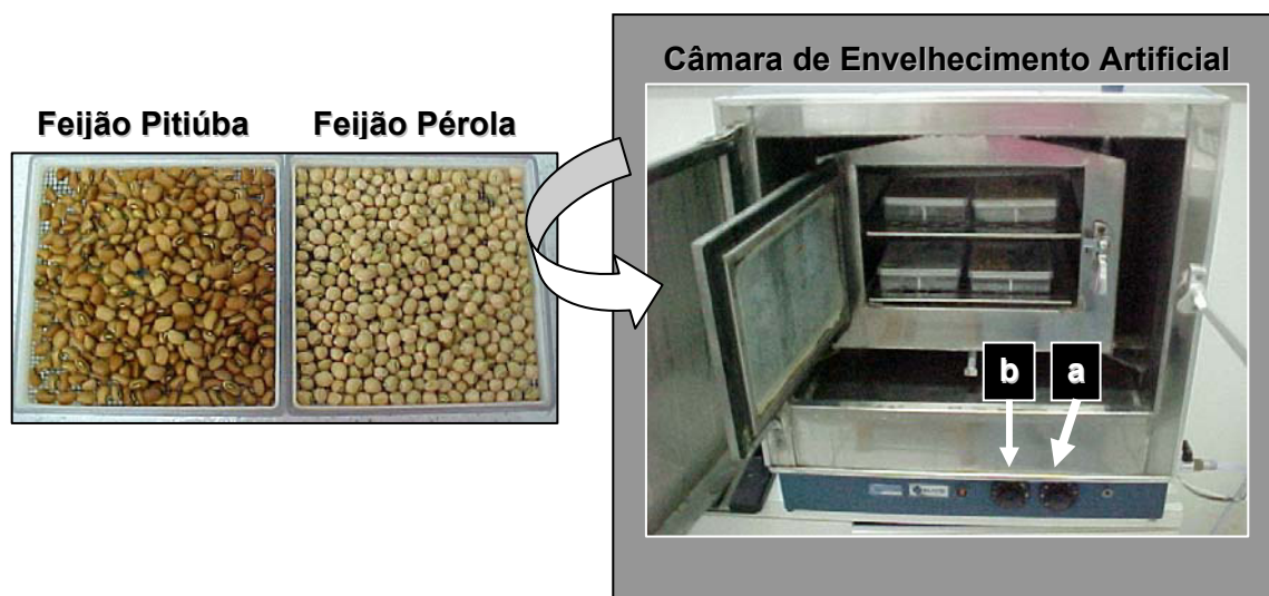
Figura 2.1. Teste de envelhecimento artificial. Transferência de sementes de feijão caupi (Pitiúba e Pérola) em caixas gerbox para a câmara de envelhecimento artificial (a- 45 °C; b - 99 % U.R.)
