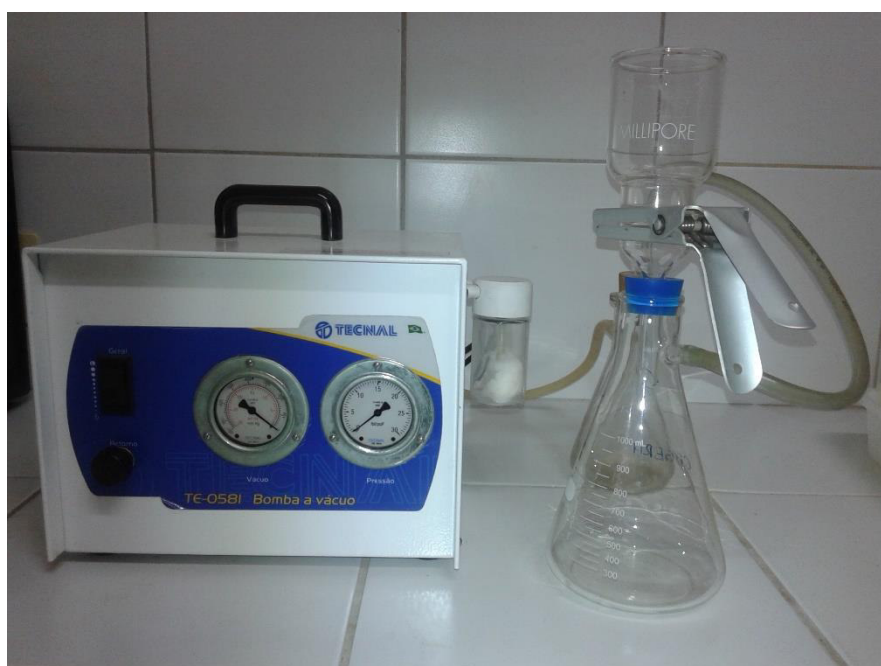
Figura 13: Bomba à vácuo utilizado na etapa de filtração.
