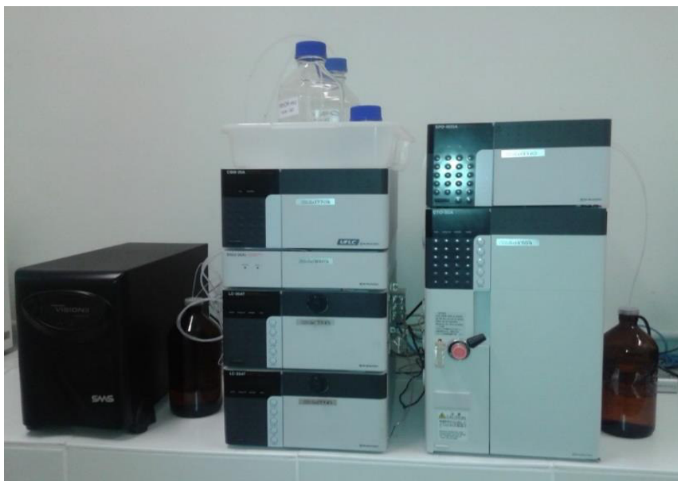
Figura 11: HPLC/DAD (SHIMADZU) utilizado na determinação dos compostos.
