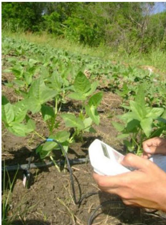
**Figura 4.1** - Umidade e condutividade elétrica do solo com o uso do sensor no experimento com feijão-de-corda, na Fazenda Experimental Vale do Curu, Pentecoste-CE
