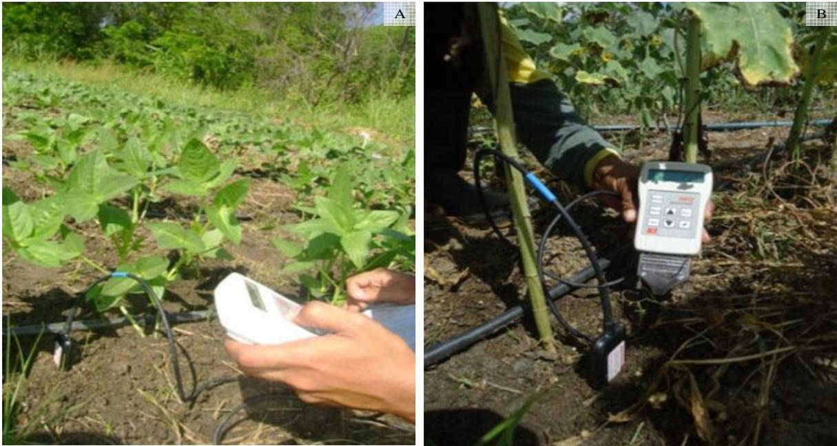
**Figura 3.12** - Medição da condutividade elétrica do solo durante o experimento com feijão-de-corda (A) e girassol (B) em experimento de campo na Fazenda Experimental Vale do Curu, Pentecoste-CE
