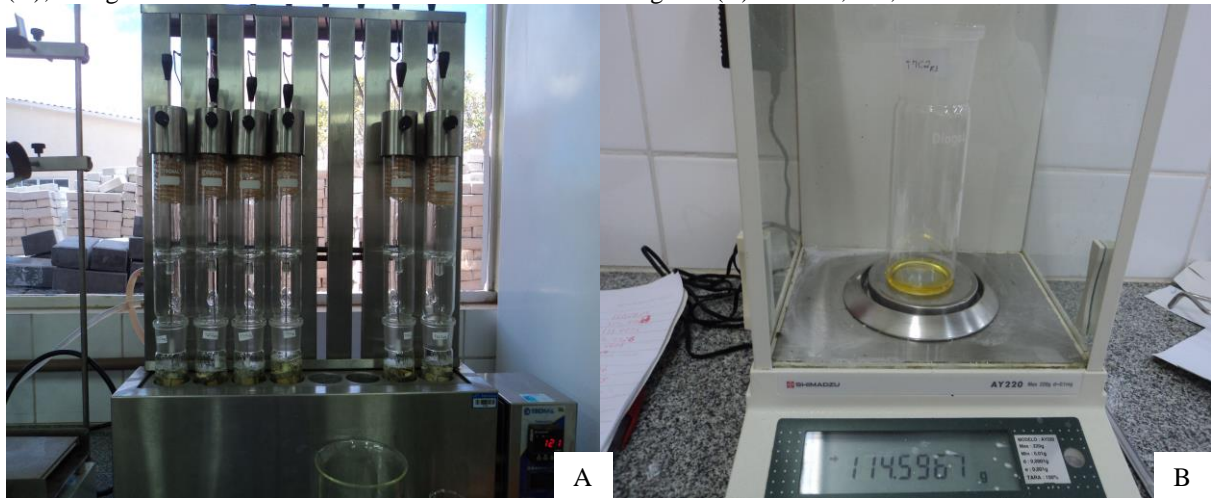
Figura 10 - Análises dos teores de óleo em grãos de soja. Aparelho extrator de gordura TE-044-5/50 da Tecnal® (A); Pesagem do tubo reboiler contendo o óleo extraído dos grãos (B). Palmas, TO, 2014
