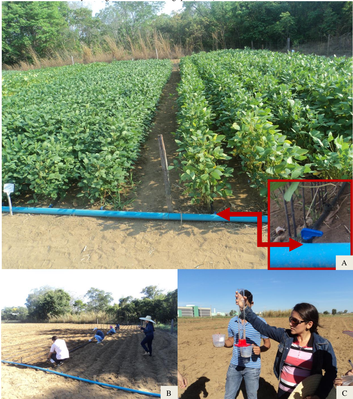
Figura 7 - Linha principal e laterais com registros no início das linhas no detalhe (A); Testes para avaliação da uniformidade de distribuição de água no sistema de irrigação (B e C). Palmas, TO, 2014
