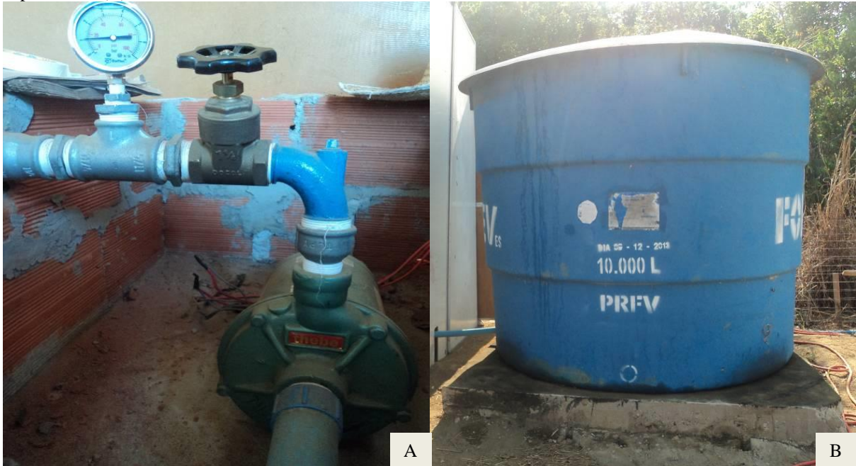
Figura 6 – Motobomba (A); Caixa d'água utilizada para armazenamento de água durante a condução do experimento (B). Palmas - TO, 2014
