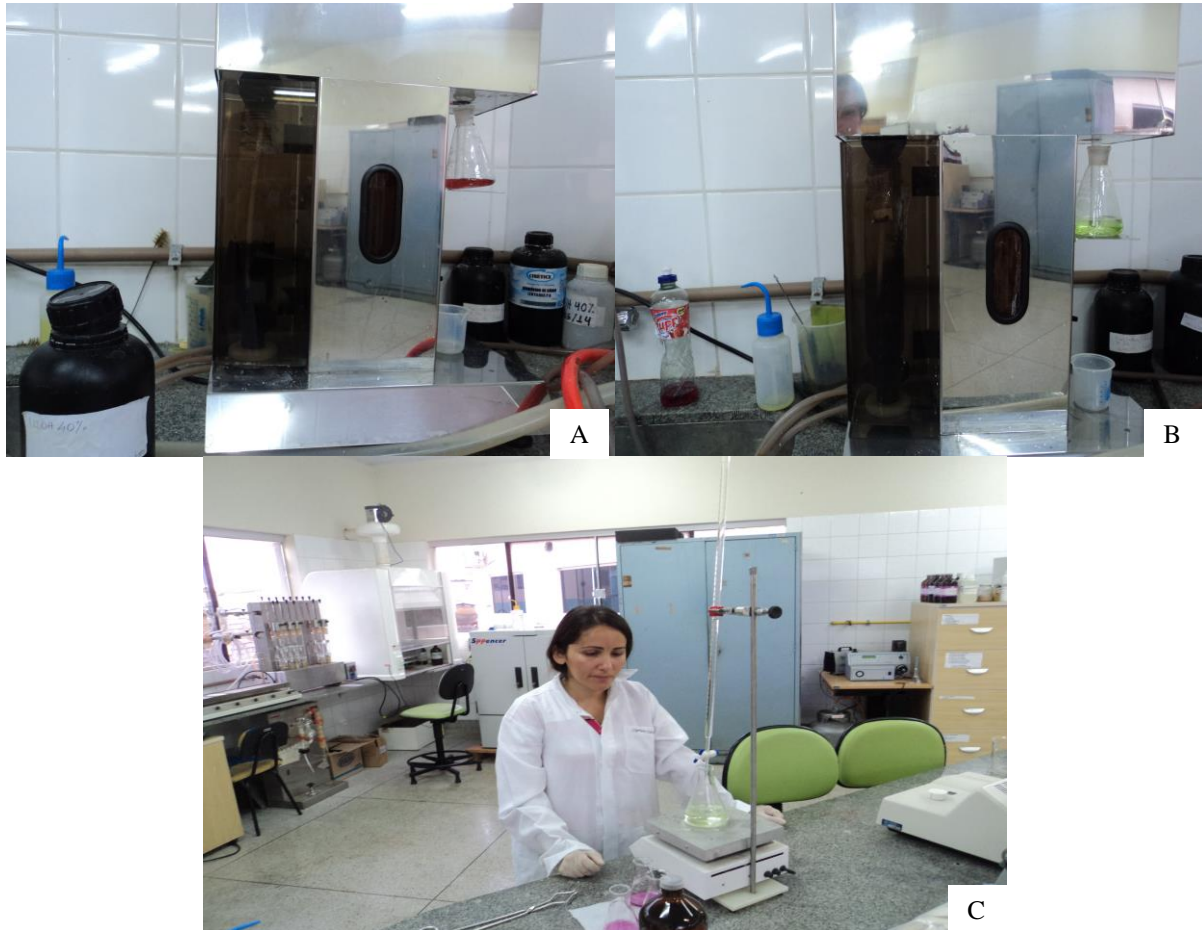
Figura 11 - Análises dos teores de proteína em grãos de soja. Destilação (A e B) e Titulação (C). Palmas, TO, 2014
