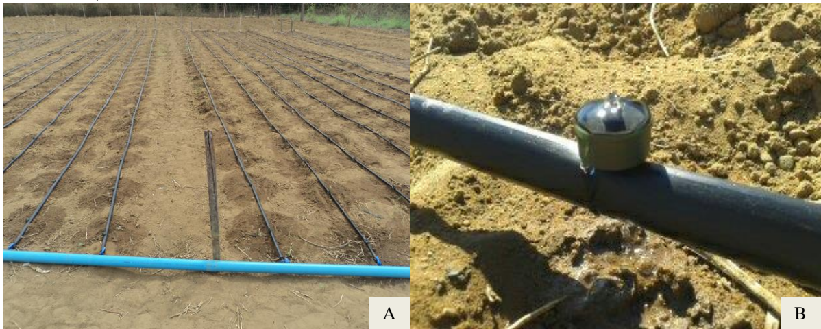
Figura 5 - Linhas principal e laterais do sistema de irrigação (A); Gotejador instalado sobre a linha lateral (B). Palmas - TO, 2014
