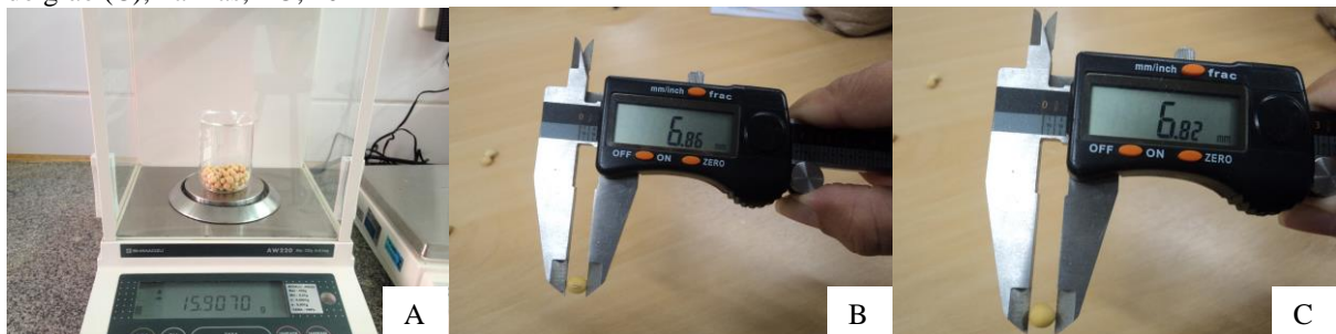
Figura 9 - Análises físicas dos grãos: Peso de 1000 grãos (A); Diâmetro polar do grão (B) e Diâmetro equatorial do grão (C), Palmas, TO, 2014
