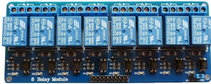
Figura 31 - Drive de acionamento
