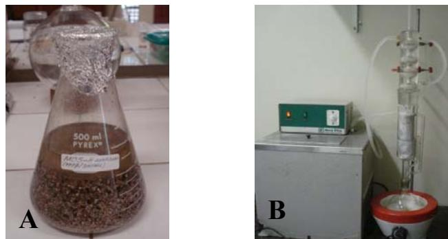
Figura 5 – Processos de obtenção dos extratos das sementes de *Moringa oleifera*. A - a frio, B - a quente em Soxhlet.
