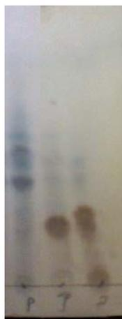
Figura 23 - Placa da Cromatografia em Camada Delgada (CCD) da análise por CLAE da fração MOS-ES-AcOEt. 1 = MOS-ES-1; 2 = MOS-ES-3; P = purga da coluna; eluente =  $\text{CH}_2\text{Cl}_2/\text{MeOH}$  (95:5) e revelador = solução de vanilina.
