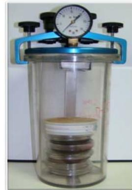
Fig. 6 Placas no interior da jarra de anaerobiose, juntamente com o anaerobac
