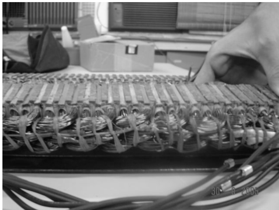
Fig. 2.16 Enrolamento trifásico do MIL (vista lateral).
