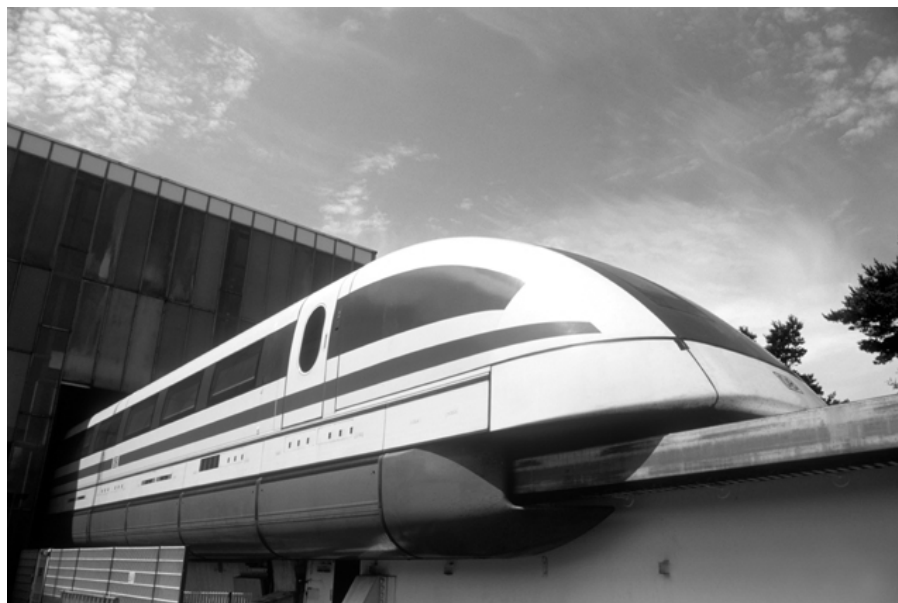
Fig 2.3 Transrapid 08 Trem de levitação magnética produzido na Alemanha.
