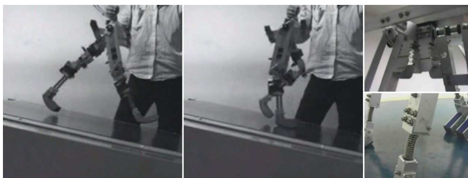
Figura 3.8: Exemplos de um robô dinâmico elástico “bípede” projetado para correr passivamente em uma superfície levemente inclinada [Owaki et al. 2012].
