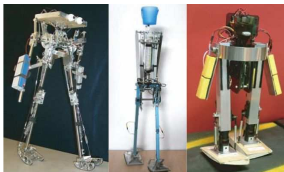
Figura 3.7: Robôs dinâmicos constituídos por componentes passivos apropriadamente projetados são capazes de caminhar em superfícies retas com pouca influência ativa [Collins et al. 2005].
