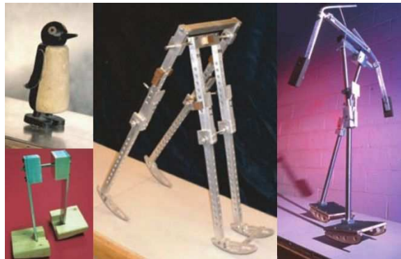
Figura 3.6: Exemplos de robôs dinâmicos projetados para caminhar passivamente em superfícies levemente inclinadas [Collins et al. 2005].
