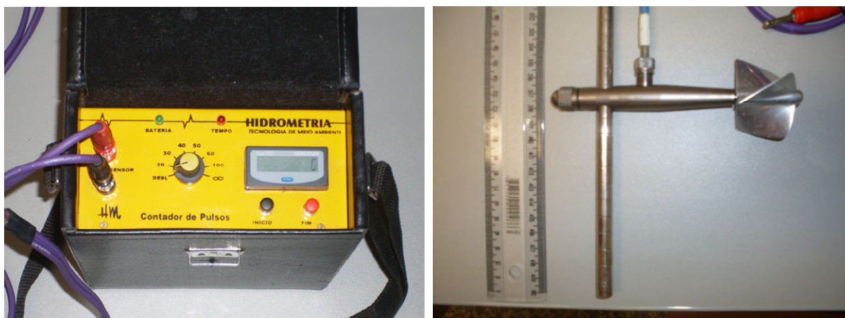
Figura 10 – Contador de pulsos marca HIDROMETRIA (A); Hélice do Micromolinete HIDROMECC
