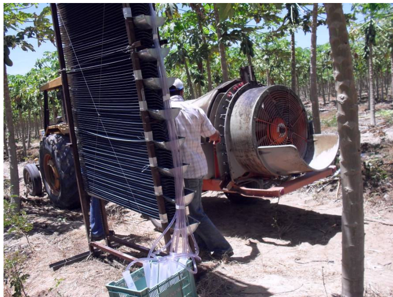
Figura 18 – Mesa vertical para ensaios de campo instalada a uma distância de 1,20 m do sistema de pulverização
