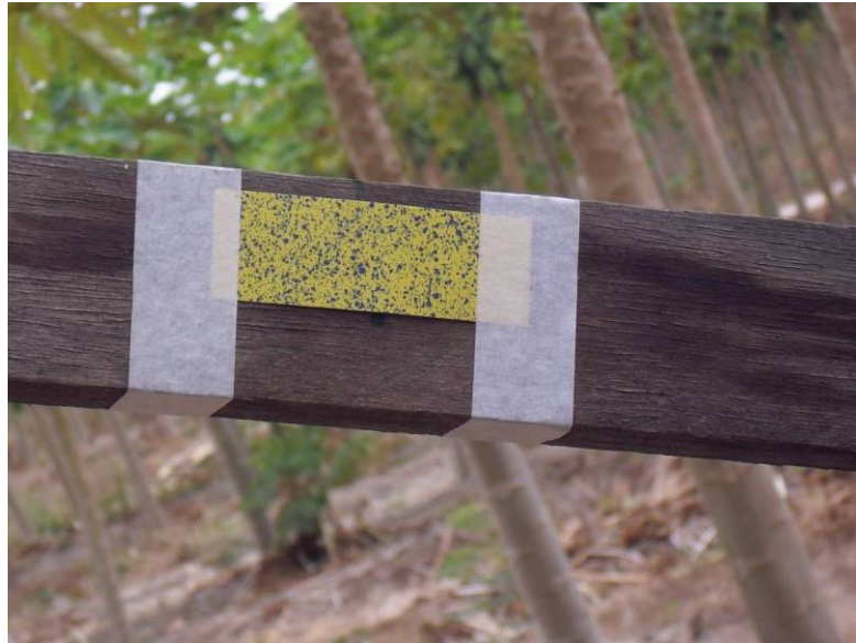
Figura 6 - Papel hidrossensível colado na torre de madeira após a aplicação da calda
