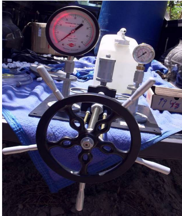
Figura 19 – Calibração do manômetro do equipamento com manômetro padrão
