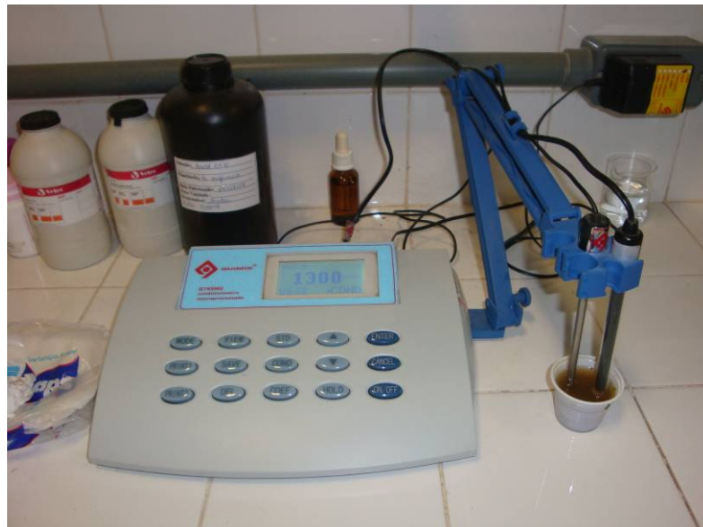
Figura 12 – Determinação da Condutividade Elétrica das soluções
