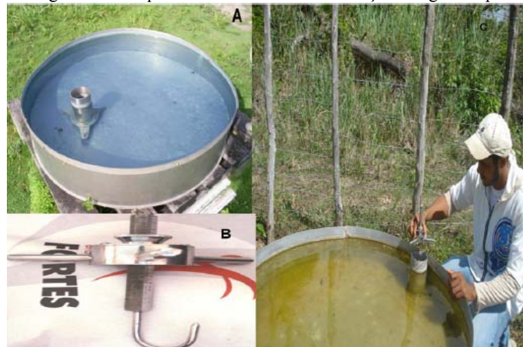
Figura 5 – Tanque Classe A destinado à medição da água evaporada
