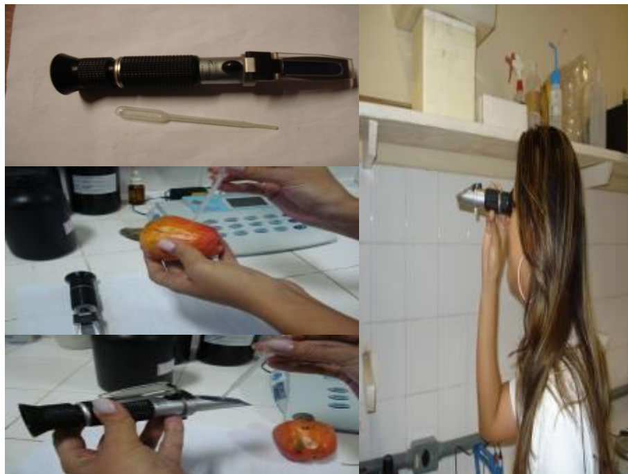
Figura 8 - Determinação dos sólidos solúveis totais (SST) com refratômetro portátil.
