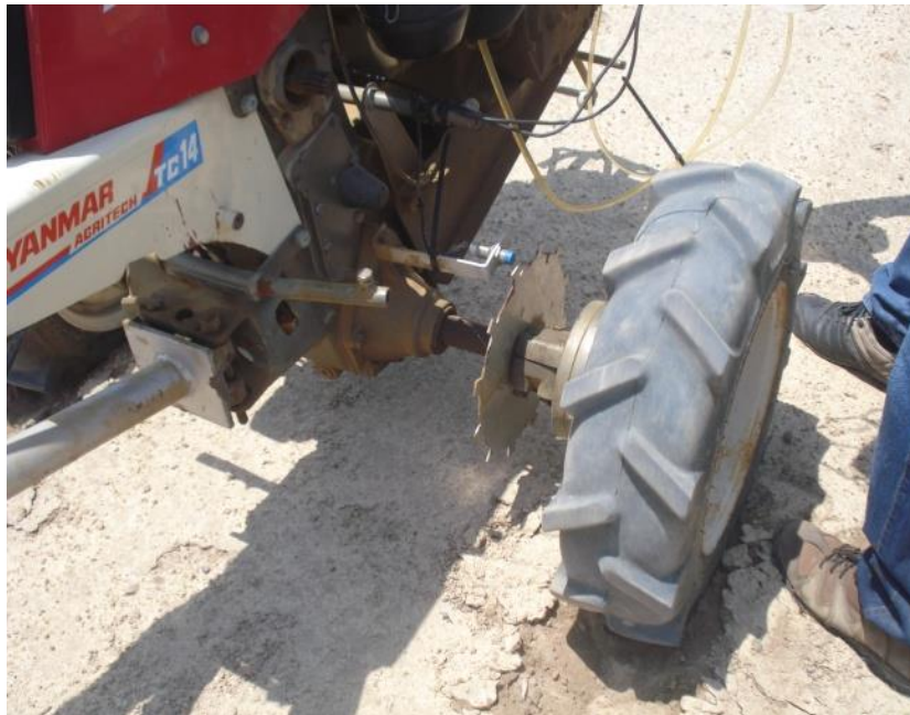
Figura 7 – Sensor indutivo localizado na roda do microtrator
