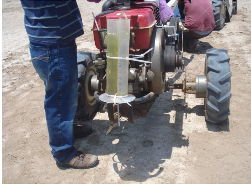
Figura 8 – Provetas para medição do consumo de combustível
