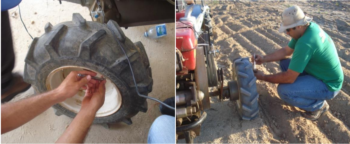
Figura 9 – Verificação da pressão de inflação dos pneus do microtrator antes de ir para o campo e durante a realização dos testes
