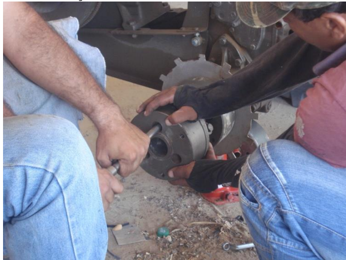
Figura 10 – Momento da colocação dos lastros nas rodas do microtrator
