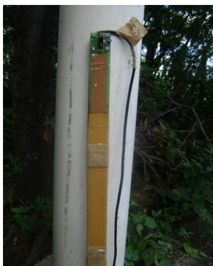
Figura 11 – Sensor de nível (linígrafo) usado para medir a altura da água na calha.
