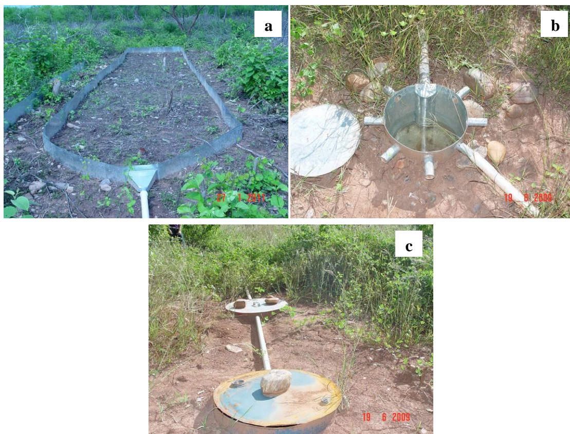
Figura 14 – Parcela experimental de erosão de 20 m 2 (a); primeiro tanque coletor (b), segundo e terceiro tanques coletores (c), Iguatu-CE
