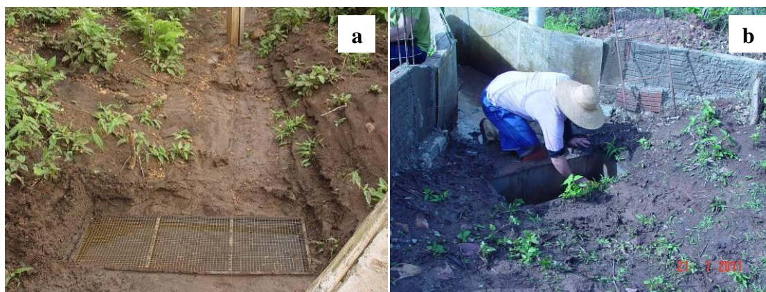
Figura 13 – Fosso coletor de sedimentos em arraste de leito (a) e em detalhe o processo de coleta de amostras de água e sedimentos (b).
