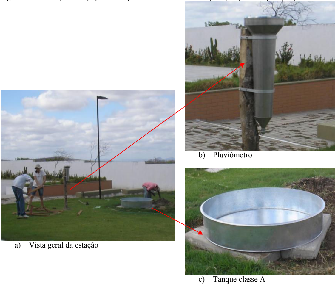
Figura 10 - Instalação de equipamentos para o monitoramento da precipitação e evaporação potencial
