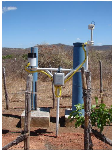
Figura 12 – Estação pluviométrica e de temperatura do ar localizada dentro da sub-bacia do riacho da Forquilha.
