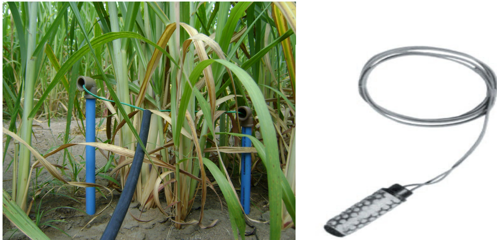
Figura 8 - Sensores watermark® utilizados no monitoramento do potencial da água do solo.
