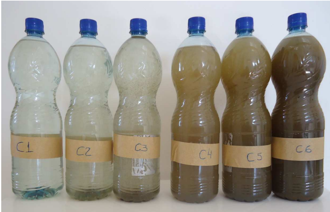
Figura 15 – Amostras com diferentes concentrações de sedimento suspenso para a calibração do turbidímetro
