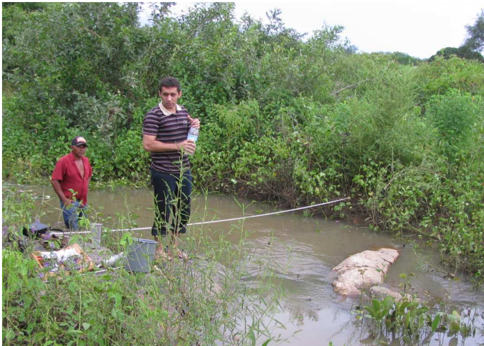
Figura 14 - Acondicionamento da amostra média de sedimento suspenso coletado na seção
