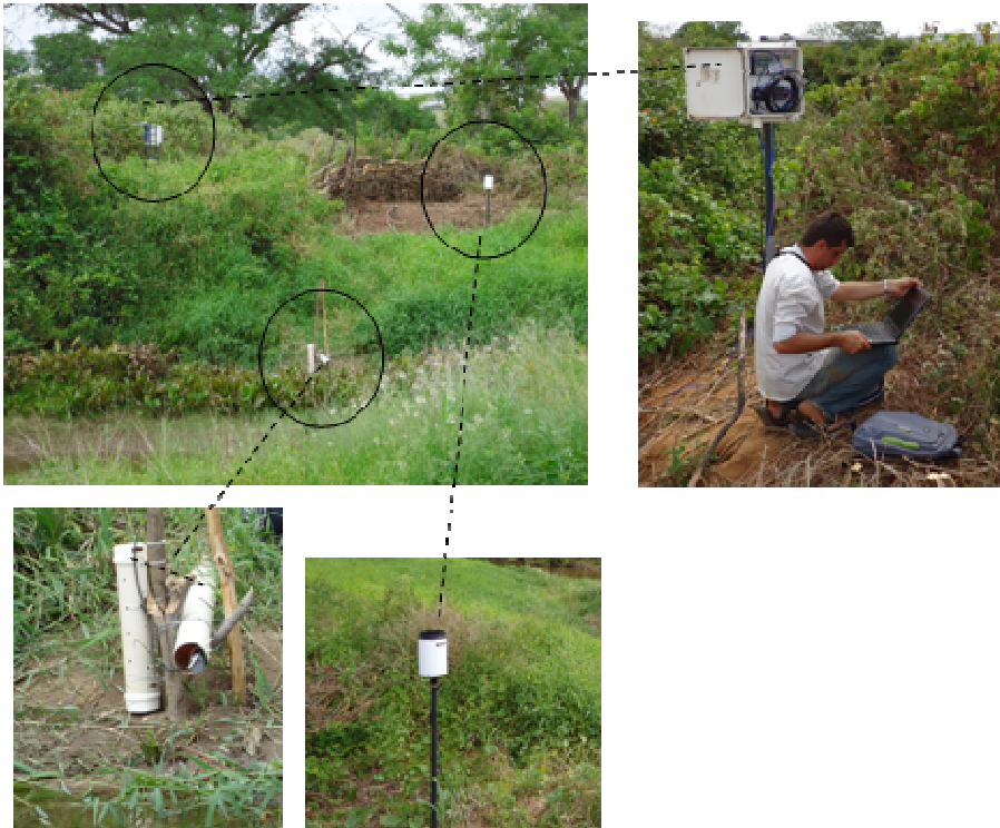
Figura 12 - Disposição dos aparelhos em campo, margem direita do canal
