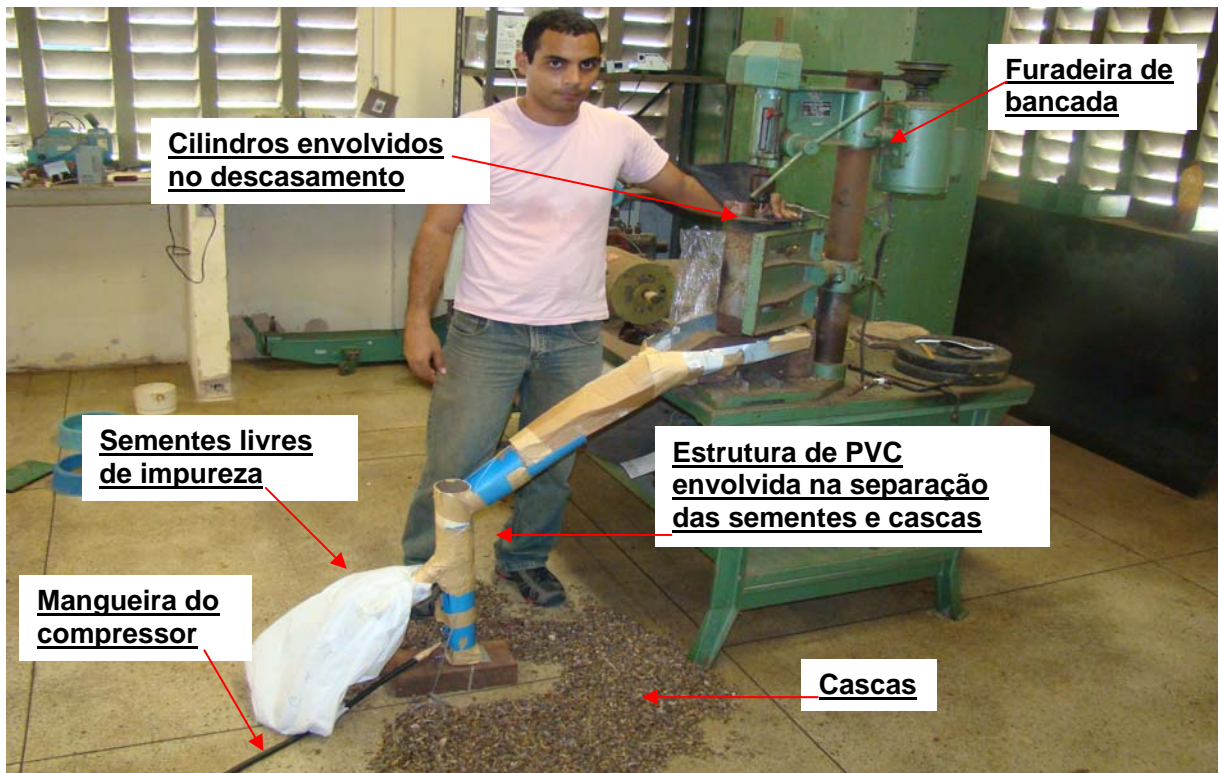
Figura 13 - Protótipo de um descascador de mamona. Fortaleza, CE, 2008.
