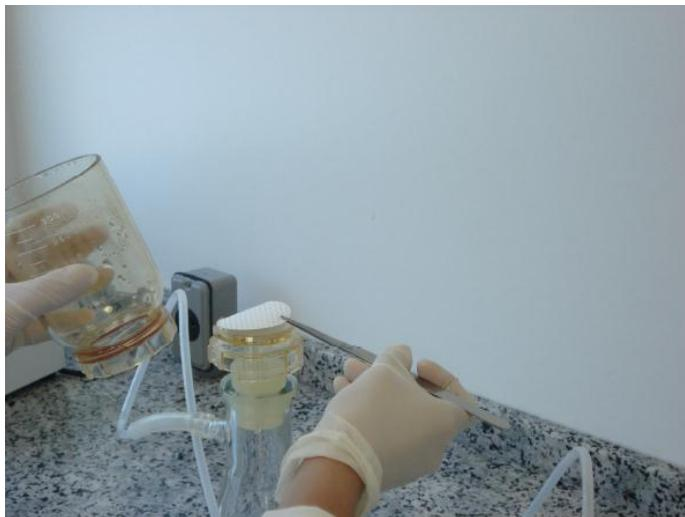
Figura 2.3– Aplicação da membrana branca, quadriculada, estéril, de 47 mm de diâmetro e porosidade de  $0,45 \mu\text{m}$  na placa de Petren (Fonte: OLIVEIRA, 2011). 11
