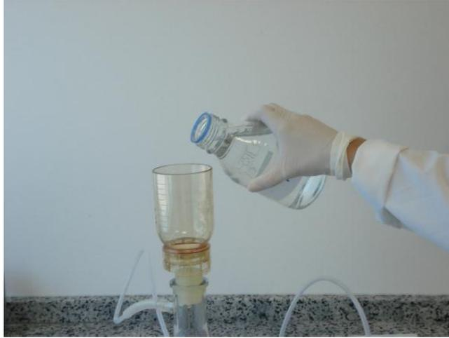
Figura 2.4 – Filtração da água realizada em recipiente inox ou de vidro (Fonte: OLIVEIRA, 2011).
